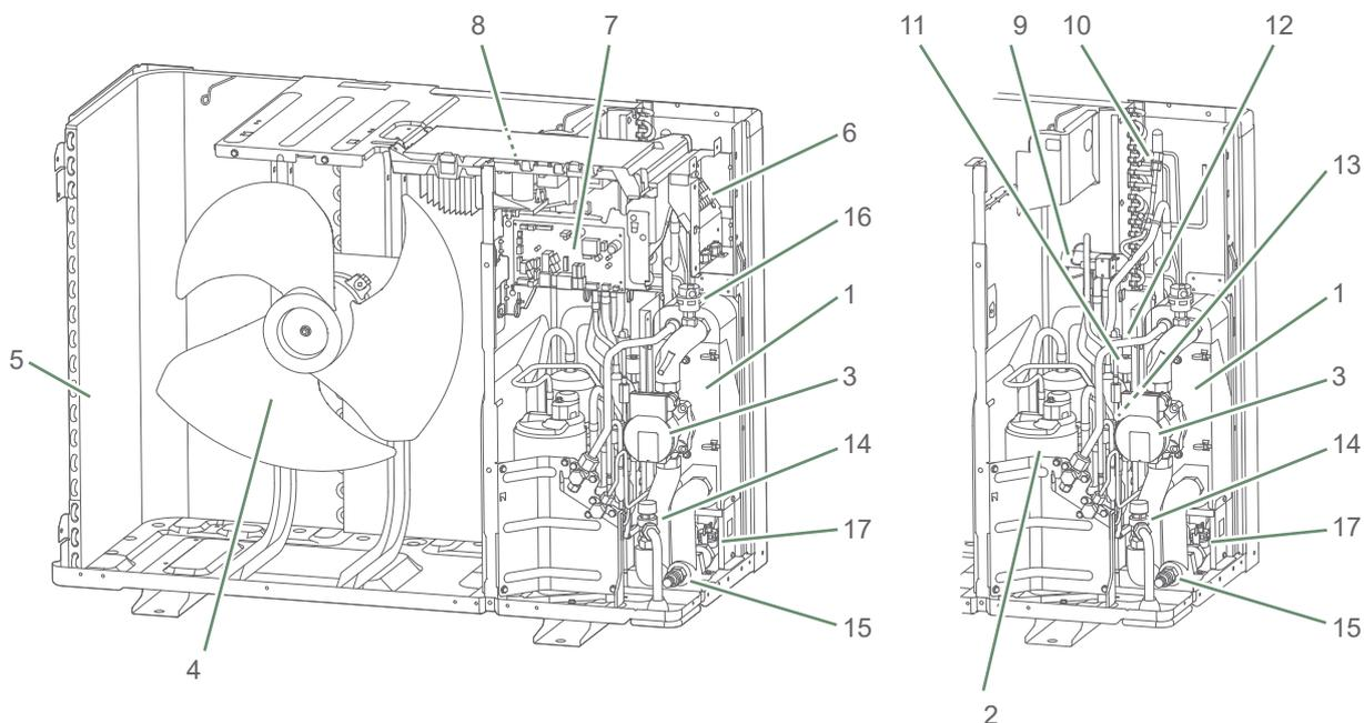
1. Plattenwärmetauscher (EP)
