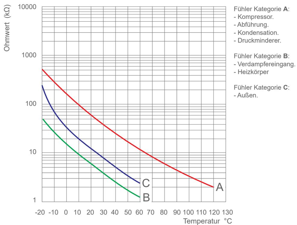
Abb. 4 - Ohmwert der Fühler (Außeneinheit)
