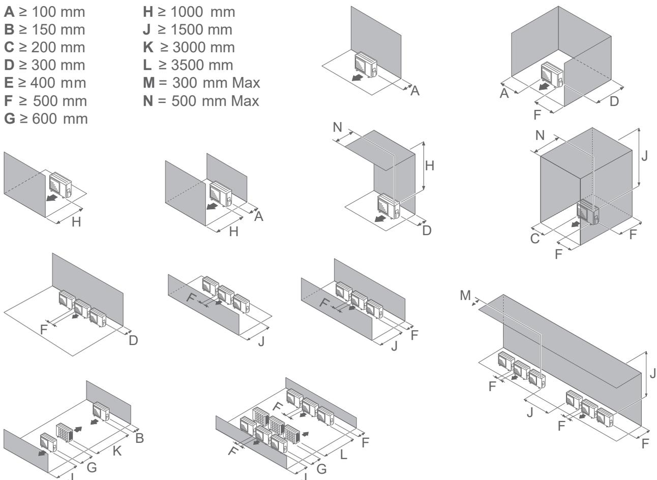
Abb. 6 - Installationsmindestfreiräume um die Außeneinheit
