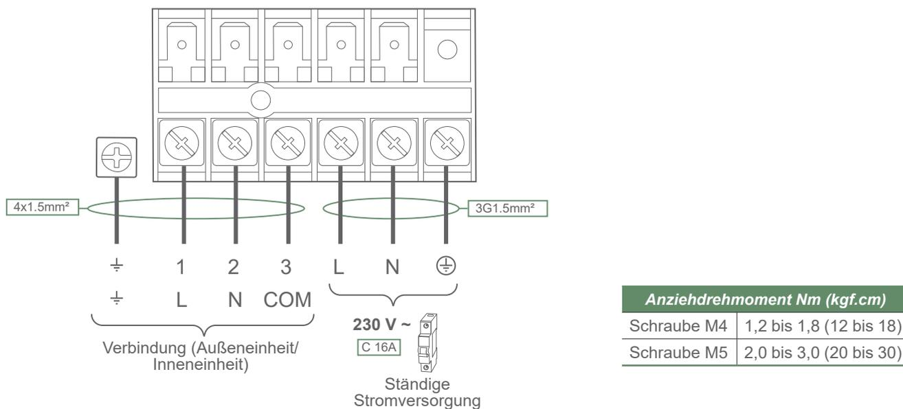
Abb. 11 - Klemmleiste für den elektrischen Anschluss der Außeneinheit
