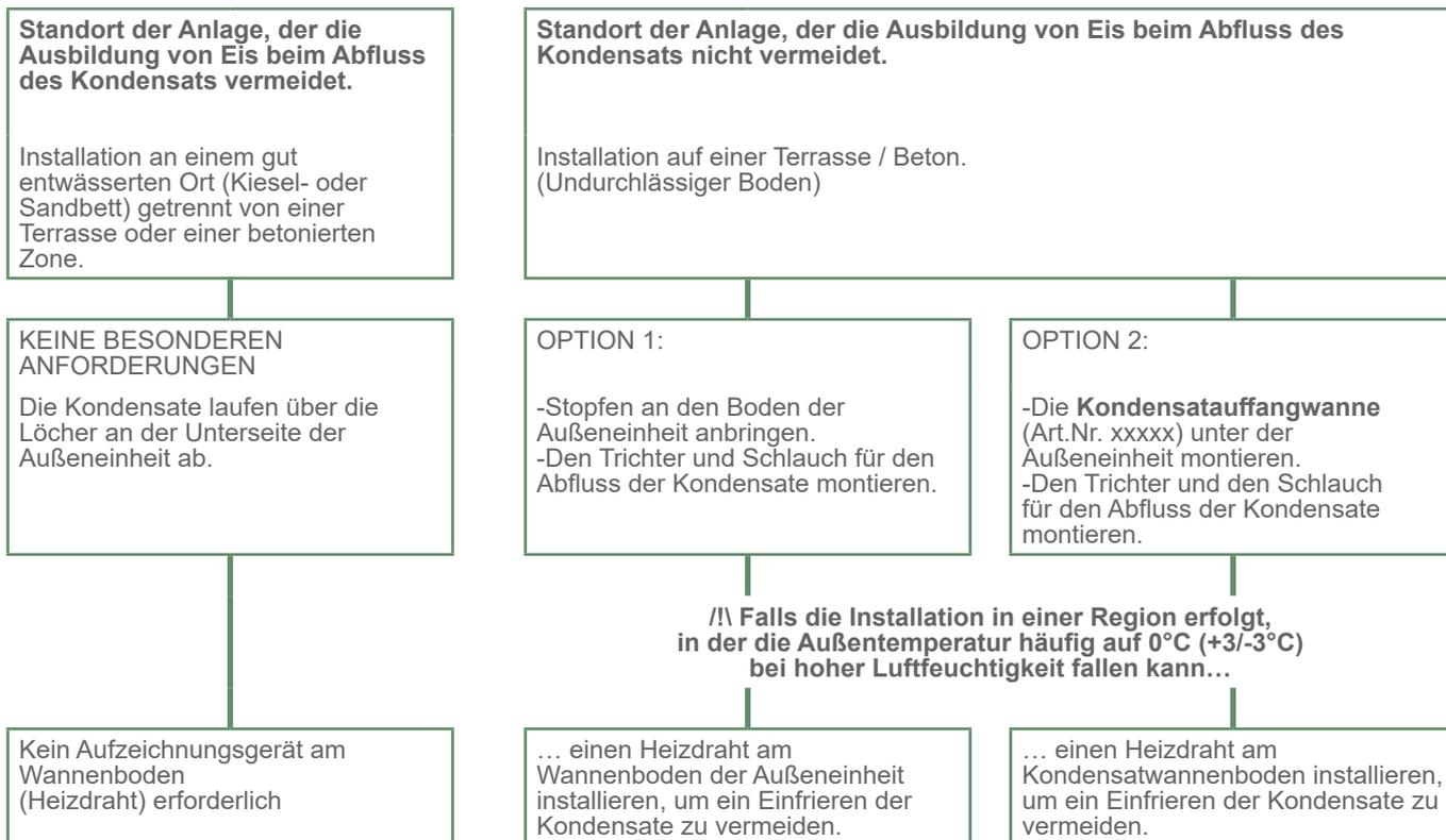
Während des Betriebs kann Wasser aus der Außeneinheit ablaufen. Das Gerät nicht auf einer Terrasse installieren, sondern an einem entwässerten Ort (Kiesel- oder Sandbett). Wenn die Installation in einer Region erfolgt, in der die Außentemperatur während längerer Zeit auf ca. 0 °C fällt, muss geprüft werden, ob Eisbildung nicht zu einer Gefahr führt.
