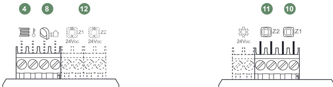
Abb. 14 - Fühleranschlüsse
