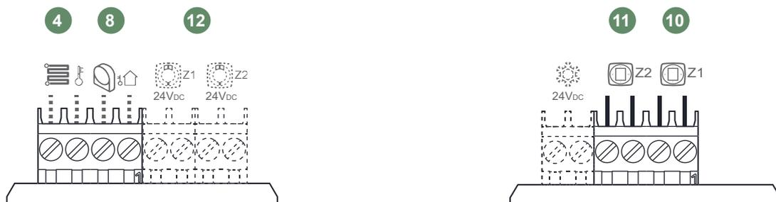
Abb. 17 - Fühleranschlüsse
